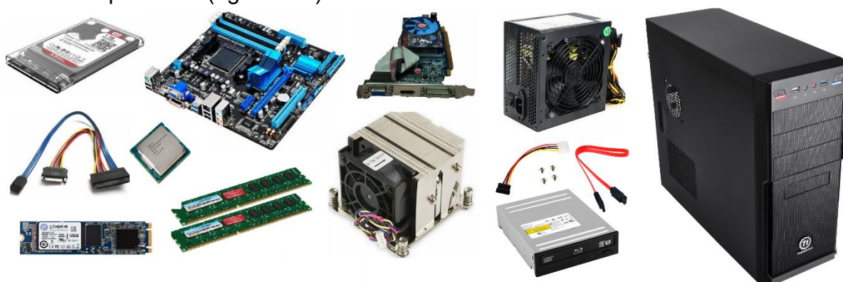
Figura 2.1. Komponentët harduerike të kompjuteri personal desktop
