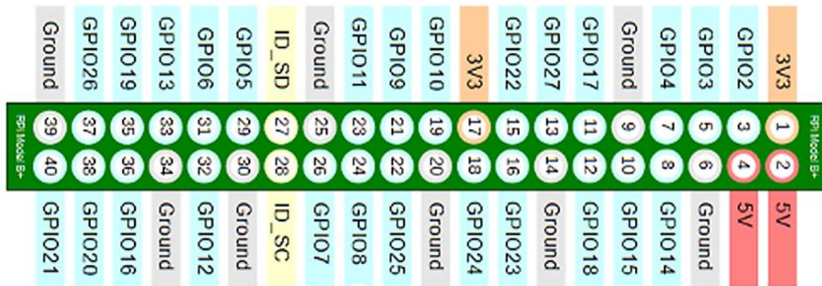
Figura 4.34. Shënimi dhe përshkrimi funksional i pinave GPIO
