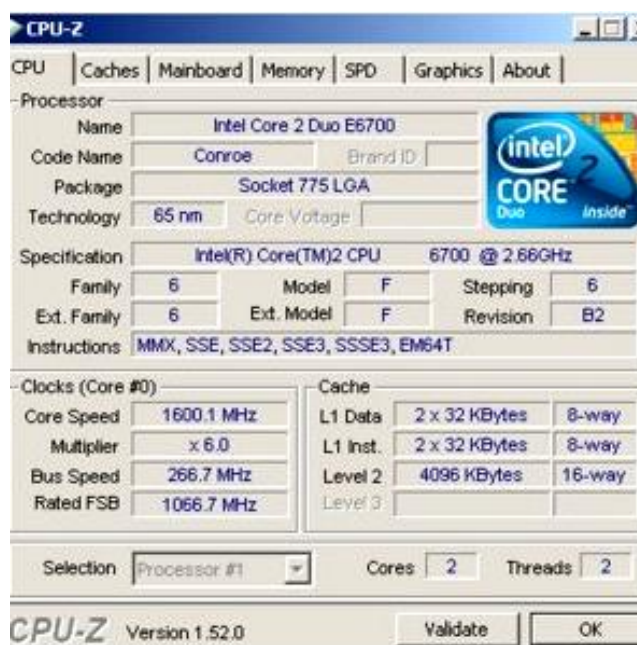
Figura 3.6. Matja e performancave të kompjuterit me aplikacionin CPU-Z
