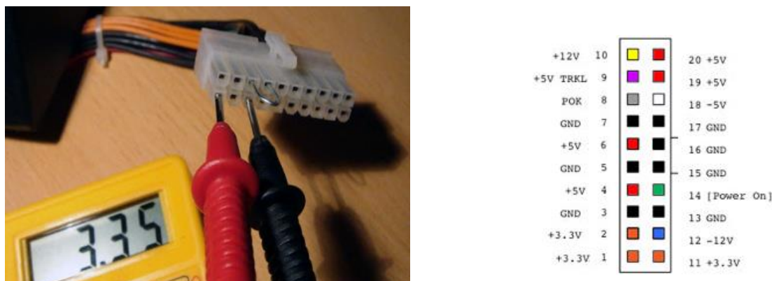
Figura 2.11. Kontrollimi i tensionit të pinave të daljes në kabllon për furnizim ATX (20+4)
